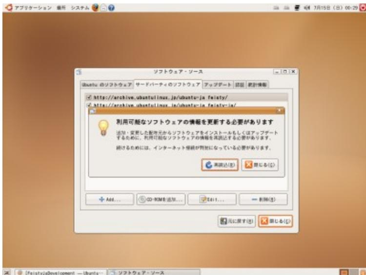
[閉じる]をクリックするとこのダイアログが出ますので、[再読み込み]をクリックしてください。GPG エラーが出ていますが、とりあえずここでは[閉じる]をクリックしてください。[ソフト
